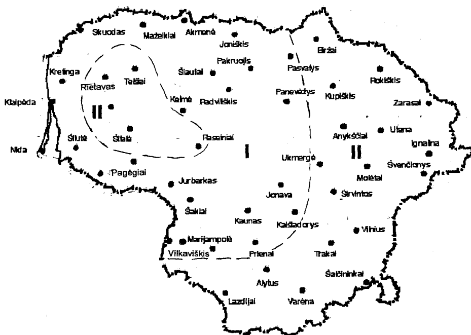
5 pav. Lietuvos sniego apkrovos rajonai I - s_k = 1,2 \text{ kN/m}^2 , II - s_k = 1,6 \text{ kN/m}^2 .
