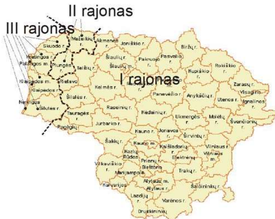
2 pav. Lietuvos vėjo apkrovos rajonai I – v_{\text{ref},0} = 24 \text{ m/s} , II – v_{\text{ref},0} = 28 \text{ m/s} , III – v_{\text{ref},0} = 32 \text{ m/s}
