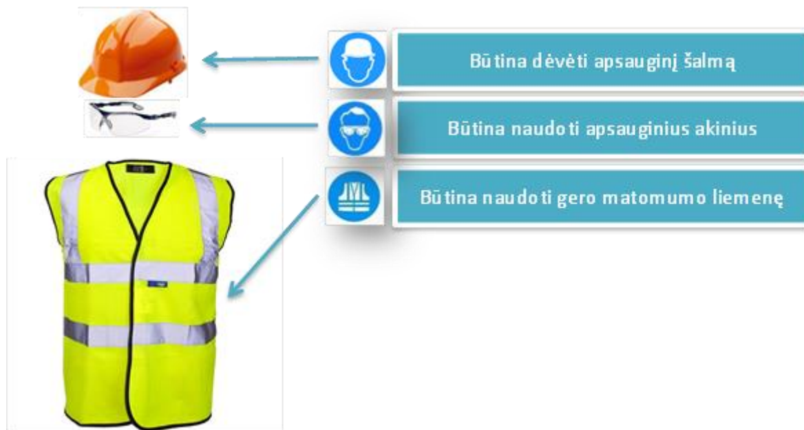
1 pav. Būtiną AAP patenkančią į KN objektų teritorijas (netaikoma patekimui į potencialiai sprogia aplinką ir technologinius įrenginius)
