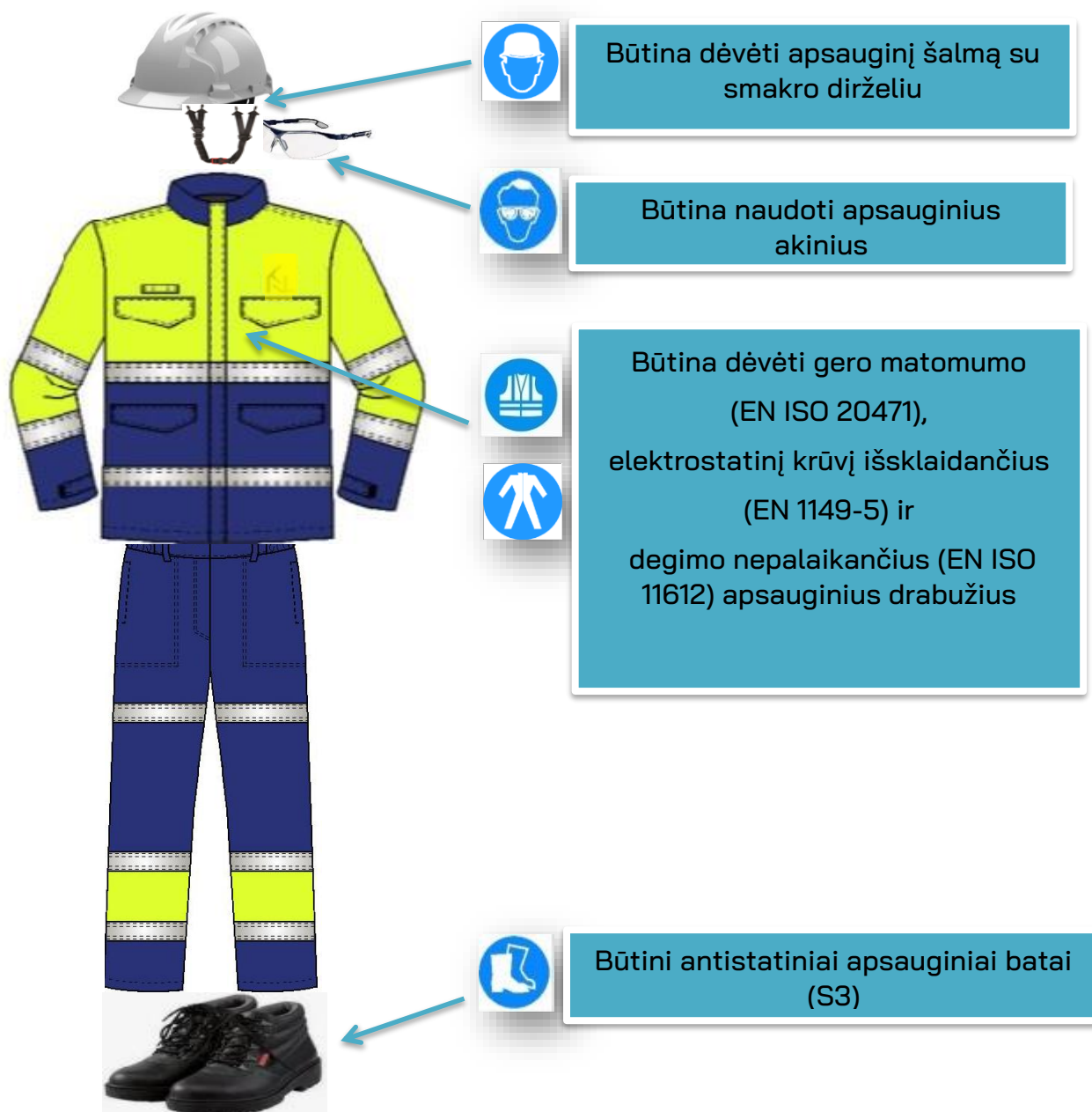
2 pav. Būtinės AAP, patenkant į KN technologinius objektus ( įskaitant patekimą į potencialiai sprogia aplinką )
