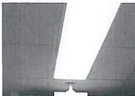
32 pav. šviestuvas montuojamas į segmentines lubas, stačiakampis
