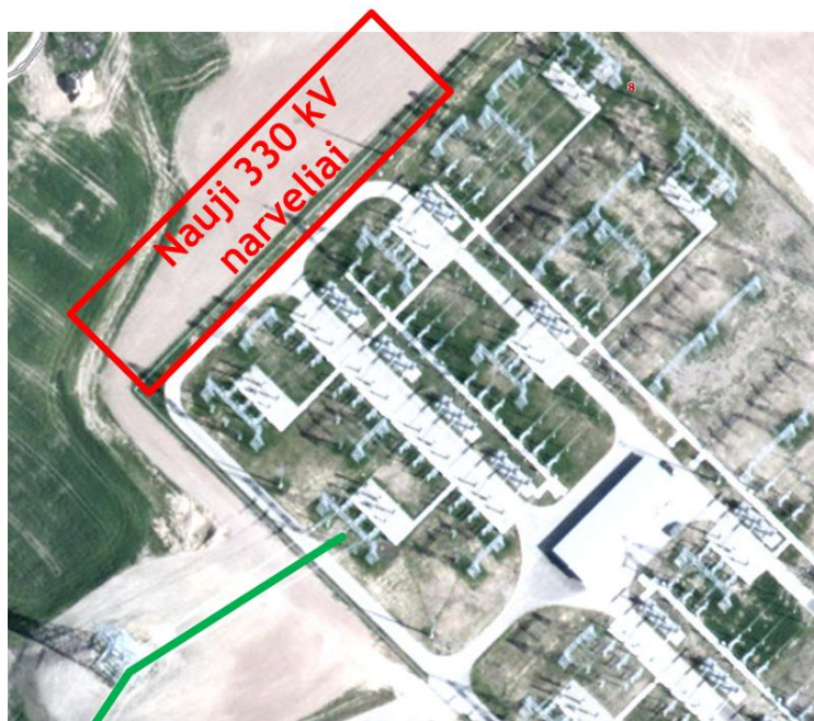
4 pav. Naujų 330 kV narvelių įrengimo vieta Alytaus TP 330 kV skirstyklos teritorijoje
