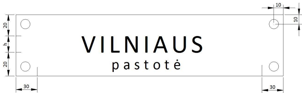
1 pav. 110-330 kV transformatorių pastočių pavadinimo lentelė
