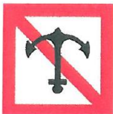
A.6. Draudžiama stovėti nuleidus inkarą ir vilkti inkarus, lynus bei grandines 5 pav. KL susikirtimo su vidaus vandens keliais ženklų pavyzdžiai
