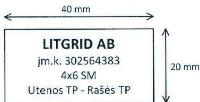
5 pav. Šviesolaidžių ir vario kabelių žymėjimo pavyzdys
