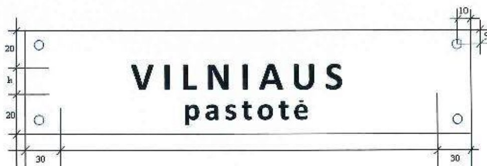
1 pav. 110-330 kV transformatorių pastočių pavadinimo lentelė
