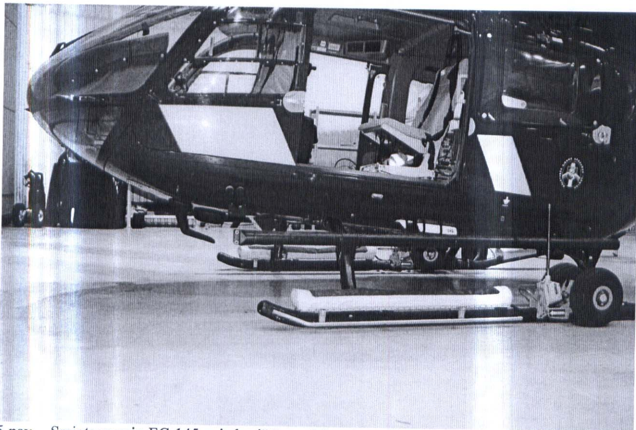
5 pav. Sraigtasparnio EC-145 vaizdas iš šono. Matyti ant slidžių sumontuoti avarinio nusileidimo ant vandens plaustai.
