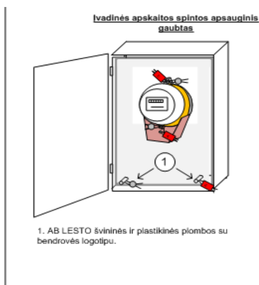
1 pav. Skaitiklio ir ĮAS plombuojamos vietos
