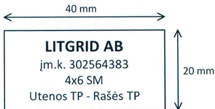
5 pav. Šviesolaidžių ir vario kabelių žymėjimo pavyzdys
