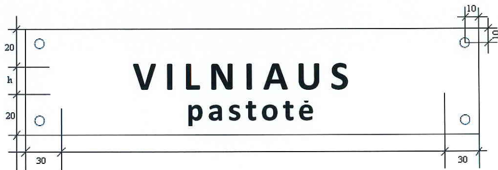
1 pav. 110-330 kV transformatorių pastočių pavadinimo lentelė
